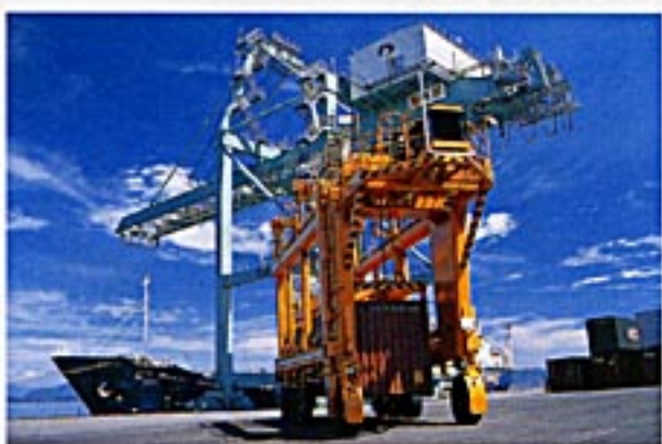
ガントリークレーン(後方)とストラドルキャリア
